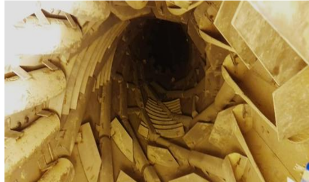
Figure 14:L'intérieur d'un tube sécheur
