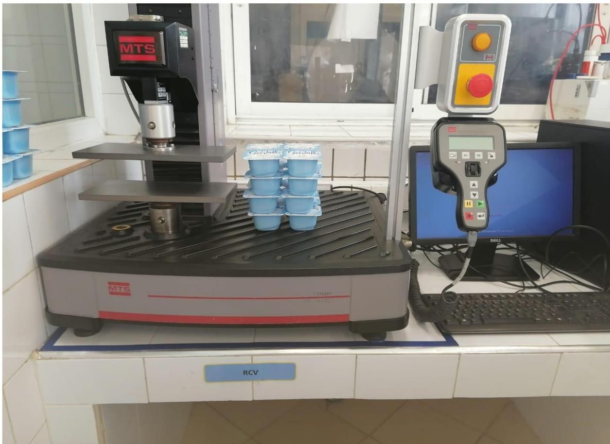
**Figure 15 : appareil de la résistance à la compression verticale**
