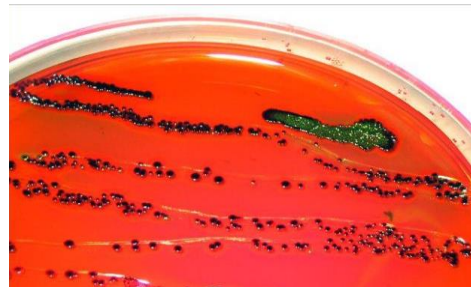
Figure 22: a) Milieu EMB : milieu non inoculé b) Milieu EMB : inoculé par les coliformes
