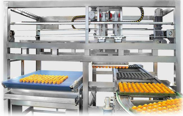
Figure 10: Démoulage des plaques
