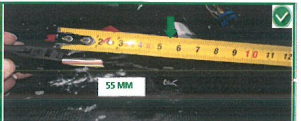
Verification de la mesure entre PDC-CK et CL-172 doit être 55 mm +05 et vérifier la présence du support KF010
