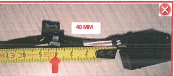
IL28 la mesure entre PDC-CK et CL-172 NOK (40MM)
