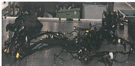
Figure 5 : Faisceau d'intérieur d'automobile
