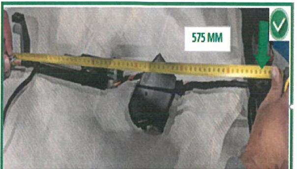
Verification la mesure entre connecteur SGLV\_CK et la noeude doit être 575 mm (+10)
