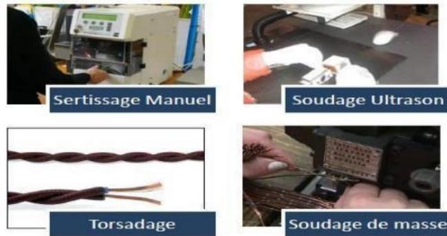
Figure 5: Les opérations du Pré-Assemblage.
