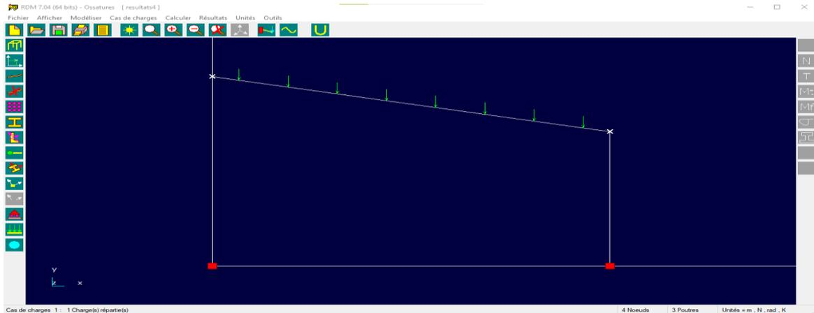
Figure 41: modélisation de la structure sous RDM6.
