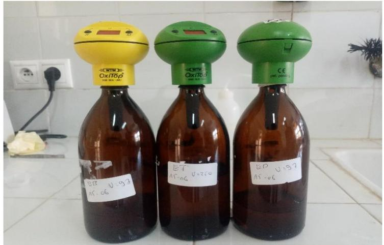
Figure 19:l'Appareil de mesure de la DBO
