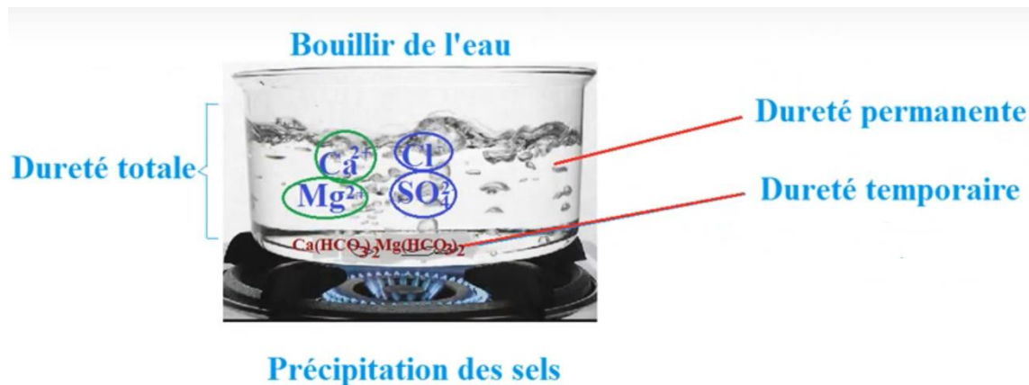
Figure 3 : Dureté permanente et temporaire
