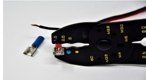
Figure 20 : sertissage de câble
