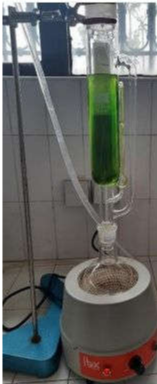
Figure2 : Extraction par appareil soxhlet
