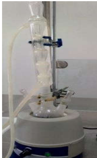
Figure 3: Extraction par reflux
