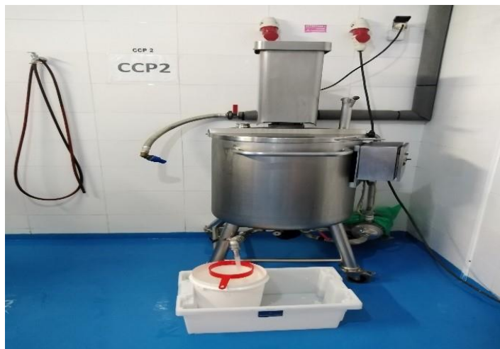
Figure 16 : le malaxeur de saumure.
