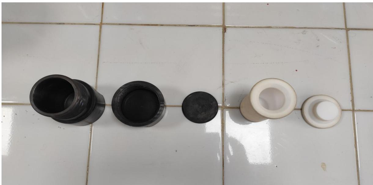
**Figure II. 3:** Autoclave utilisé en synthèse hydrothermale.
