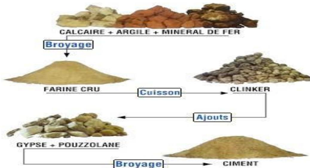
Figure 1.4 Procédé de la fabrication du ciment.
