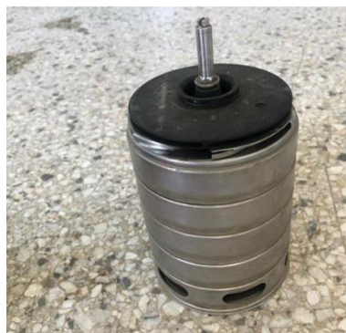
Figure 6: Turbines d'une pompe démontée à Elec Energie.
