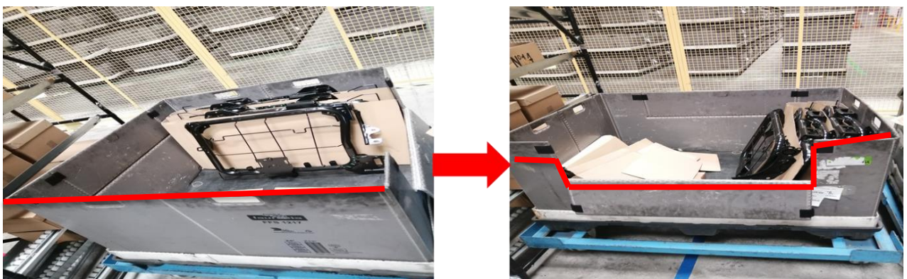
Figure 28 : La bonne mise en place des boites des armatures.
