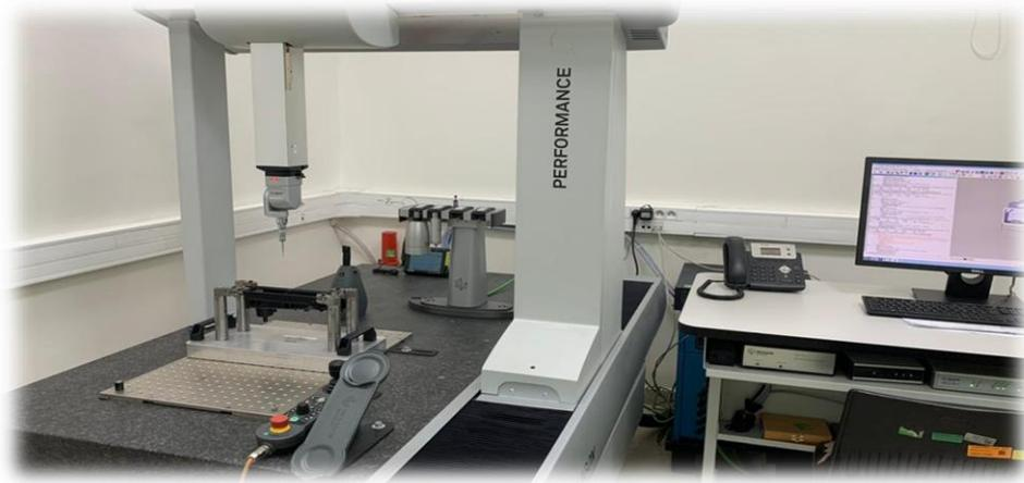
Figure 13 : La machine la plus utilisée pour le contrôle de qualité dimensionnelle.
