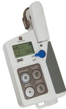
**Figure 6 : Appareil de mesure de la teneur en chlorophylle mètre de model SBAD-502**
