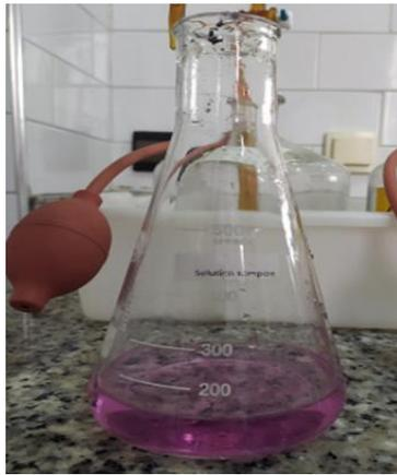
*Figure 12. Virage de la solution au rose.*
