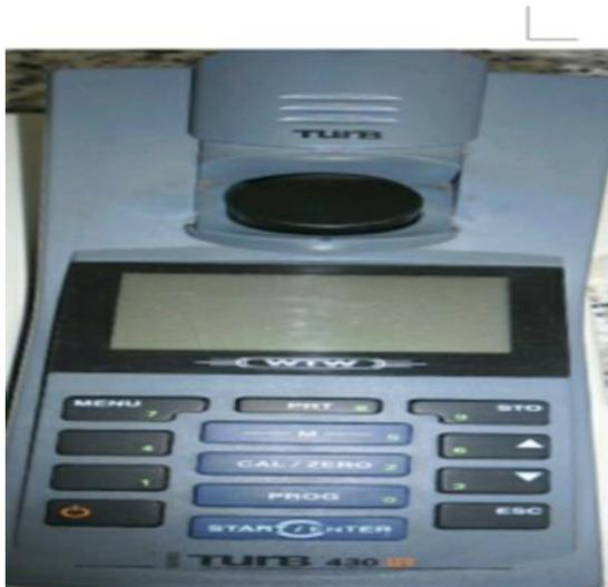
*Figure 9. Turbidimètre.*
