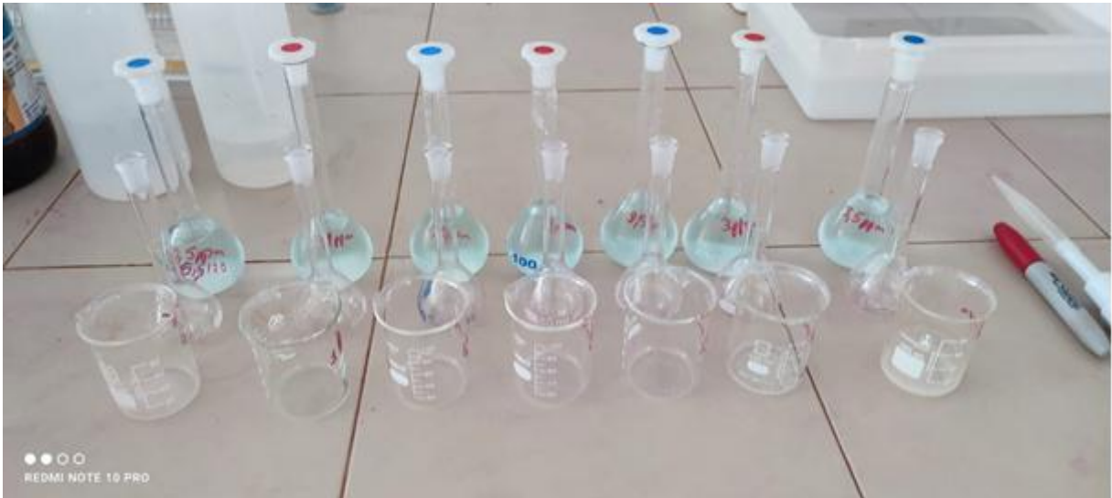
Figure 6 : Une gamme Figure standard (0,5ppm - 3,5ppm) à base de KNO 3
