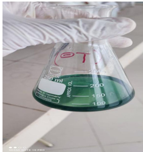
Photo 16 : Après titrage avec une solution de sulfate de fer.
