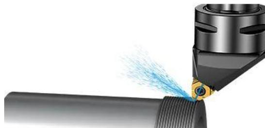
Figure 3. 31 : Opération De filetage
