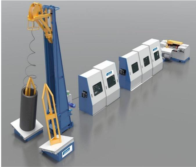
Les lignes de laminage à froid sont conçues pour produire du fil d'acier lisse ou cranté laminé à froid pour les armaturiers et les utilisations industrielles.
