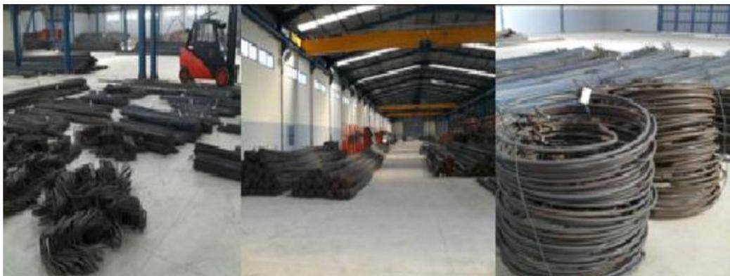
**Figure 1. 2 : Les armatures coupées façonnées**
