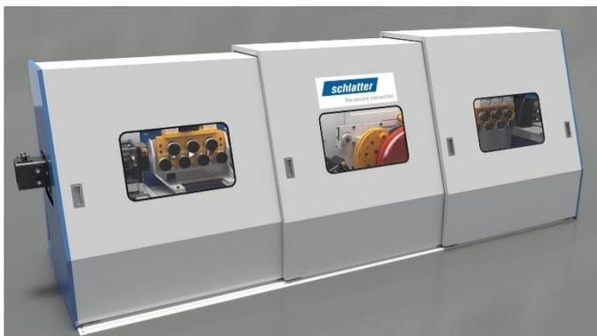
Le bloc Bull HBB horizontal tire le fil d'acier au moyen de cabestans spéciaux, assurant la force nécessaire pour le processus de laminage à froid ou d'étirage.
