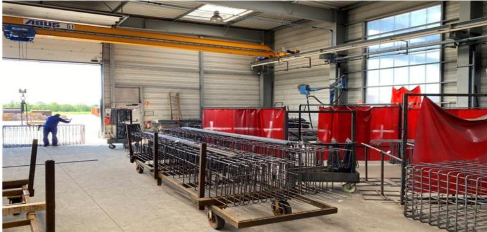
Figure 2. 2 : Armature coupées façonnées
