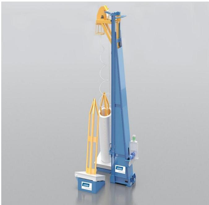
Le système de déroulement vertical VPS est utilisé pour dérouler des rouleaux de fil laminé dans des diamètres de 5,5 mm à 16 mm, tout en assurant une alimentation continue de la ligne.
