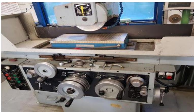
**Figure 2. 5 : Rectifieuse plane**
