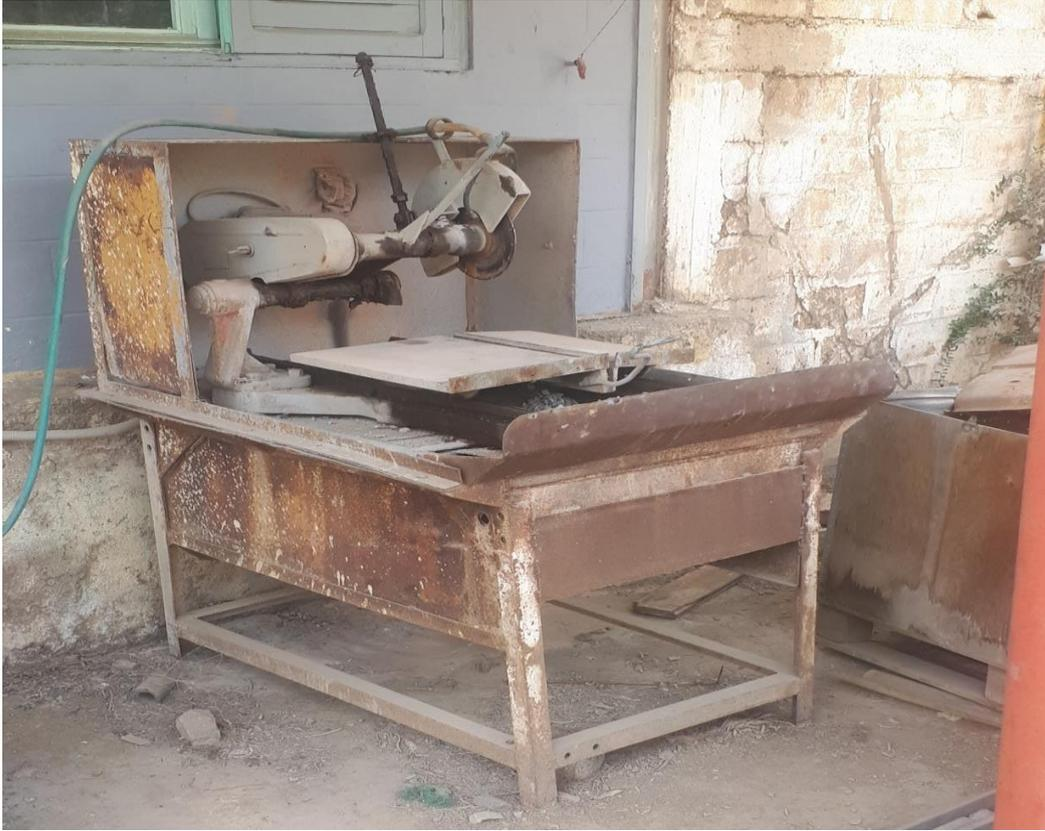
Photo 8 : machine de sciage
