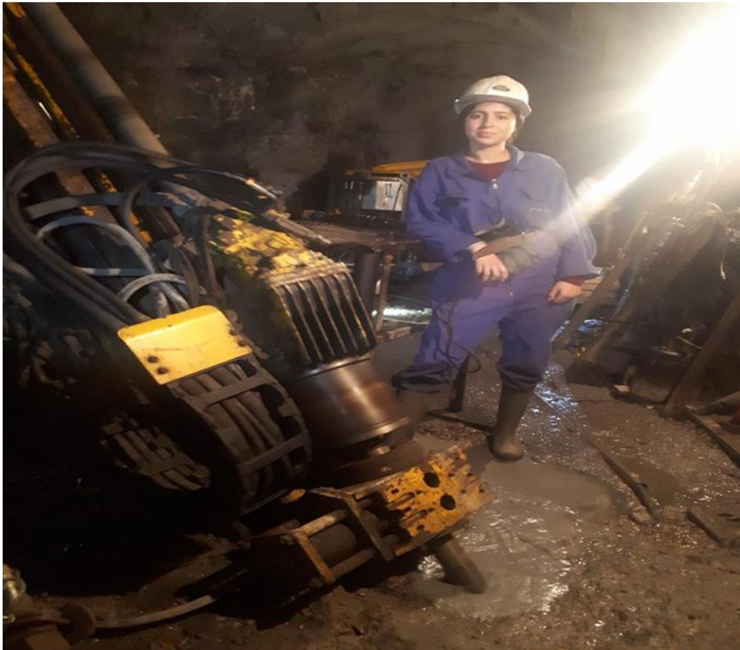
**Photo4 : la sondeuse machine pour la réalisation des sondages carottés**
