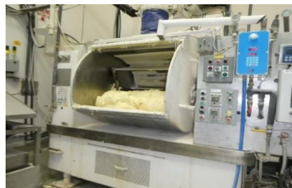
Figure 6 : pétrin horizontal à pâte [6]
