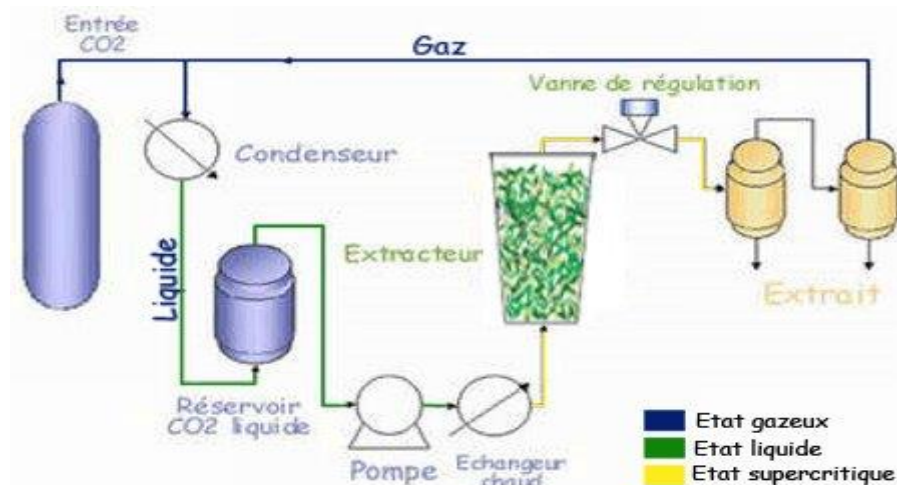
Figure 5:Schéma du principe de la technique d'extraction par CO 2 supercritique.
