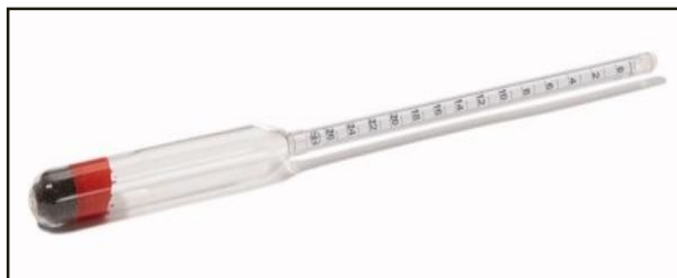
Figure 13: Image d'un Aéromètre pour évaluer le taux de sel dans la saumure.
