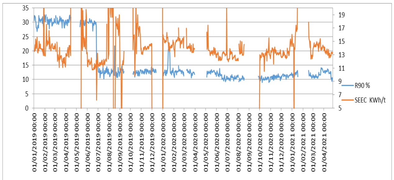
Figure 31 : Diagramme de la variation de la CE et la finesse cru en fonction du temps.
