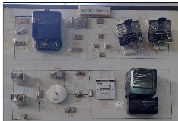
Figure 8 : Constitution d'un compteur monophasé
