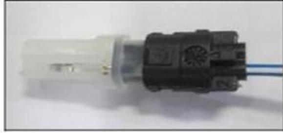
*Figure 5 : Connecteur avant moulage*
