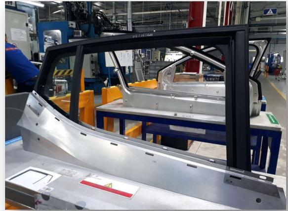
*Figure 3: coulisses de vitre des portes arrière*
