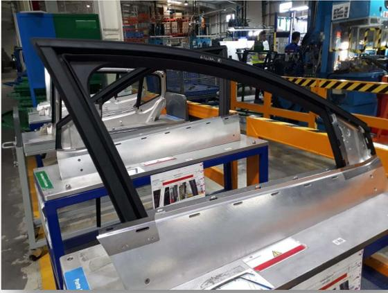
*Figure 2: coulisses de vitre des portes avant*
