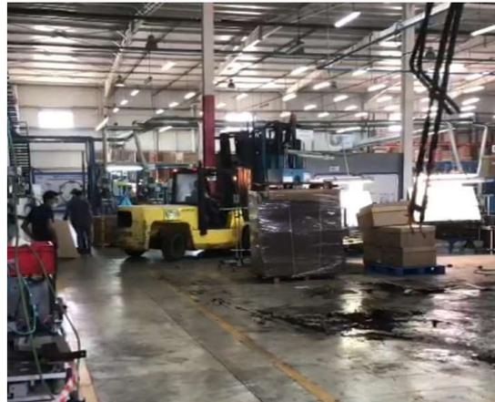
*Figure 19: Balisage de la zone et déplacement des machines*
