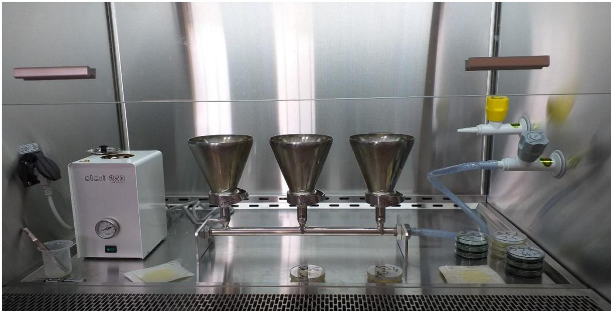
*Image 5 : rampe de filtration des échantillons par la méthode de filtration sur membrane*
