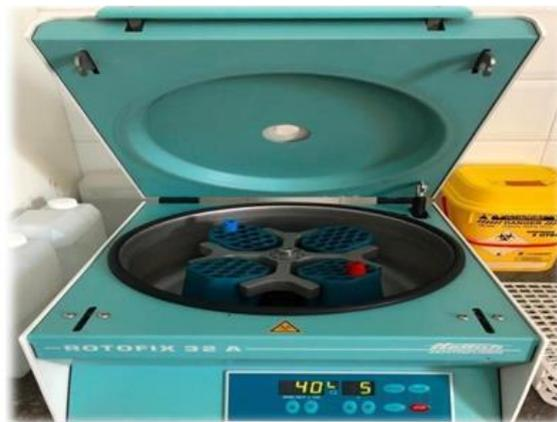
**Figure 15: la centrifugeuse**
