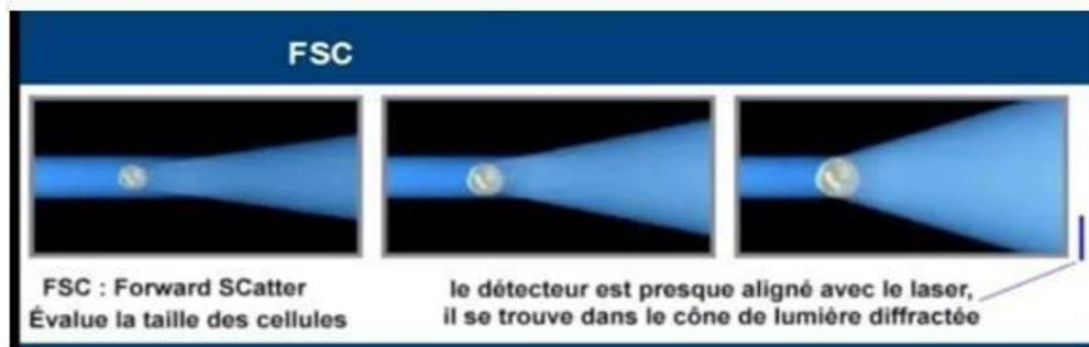
Figure 17 : technique de fluoro-cytométrie(détecteur FSC)
