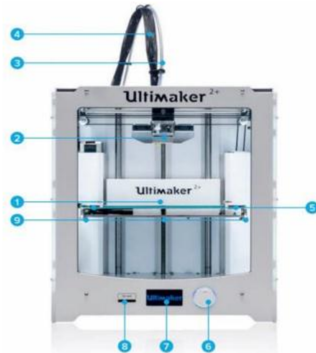
figure 60 : les composants d'Ultimaker
