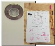
UNE IDÉE Ici un coupe lux avec grille anti éblouissement pour un projecteur encastré plafond
