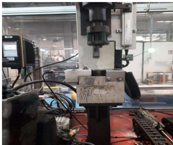
Figure 19: Opération de Rivetage dans la machine KMK-15
