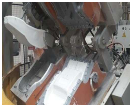
Figure 8: la pièce finale après moulage.
