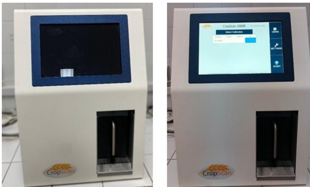
Figure 14 : Dispositif de l'analyse infrarouge proche (Near InfraRed Spectroscopy).
