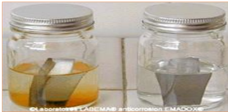
Figure 6 : Plaque en fer au contact d'un milieu corrosif : (a) sans inhibiteur de corrosion (b) : avec inhibiteur de corrosion
