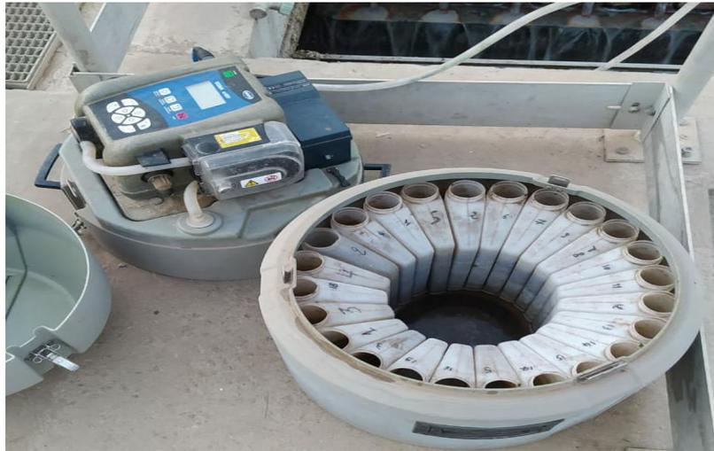
*Figure 1: illustration d'un échantillonneur automatique en sortie du STEP*
