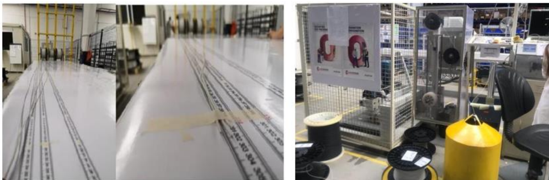
Figure 14: Table de coupe câbles et la machine KOMAX KAPP
