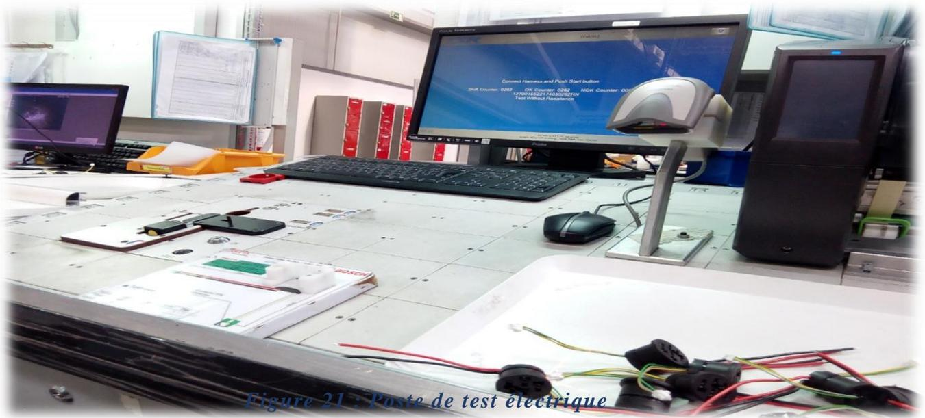
Le test électrique a pour but de tester la continuité et la résistance des fils.
