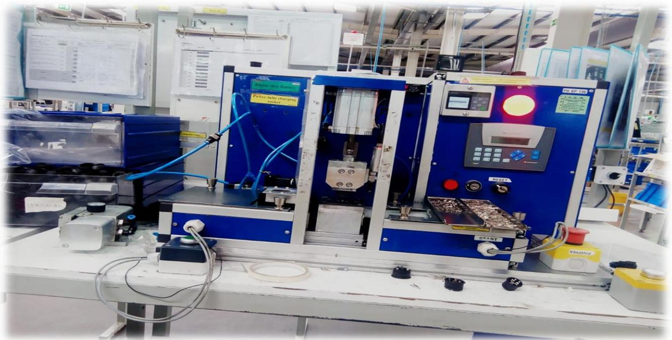
*Figure 11 : Machine d'insertions des fils*
