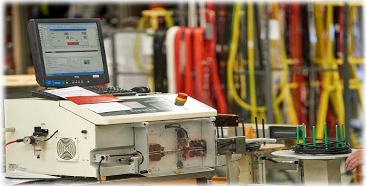
*Figure 10 : Machine de coupe KOMAX*
