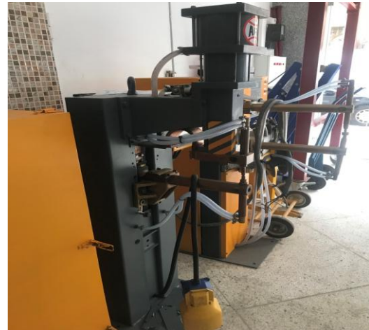
Figure 1 : machine de soudage par points.
