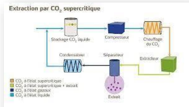
Figure 6: Schéma d'extraction par CO 2 fluide supercritique
