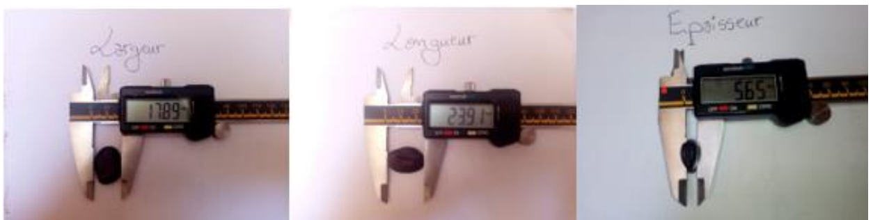
Figure 11 : Pied à coulisse utilisé, montrant les paramètres mesurés sur les graines.
