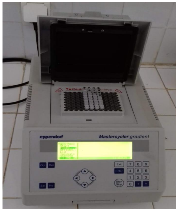
Figure 8: Thermocycleur pour la PCR (Source : Photographie personnelle, 2021)
