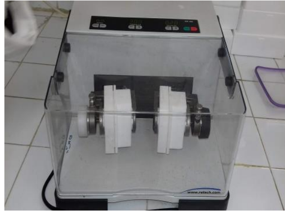
Figure 5: Broyeur à billes (Retech MM400). (Source : Photographie personnelle, 2021)
