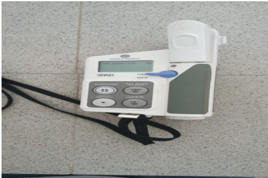
Figure 8 : appareil de mesure de chlorophylle de model SPAD_502 (INRA-CRRA-Meknès)
