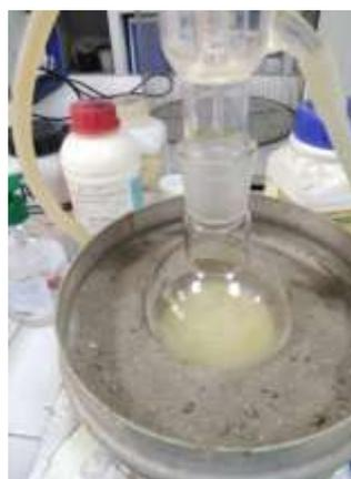
**Figure 17 : Réaction de formation de la base de Schiff désirée.**
