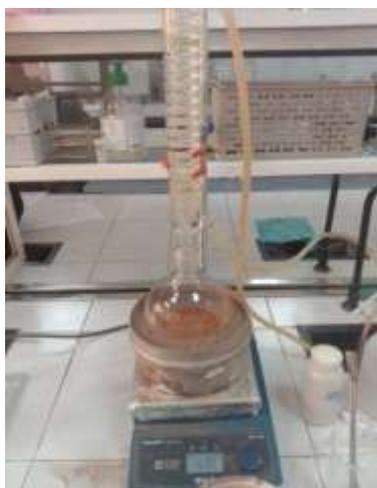
**Figure 10 : Carapaces de crevettes chauffées à reflux pendant 3h.**
