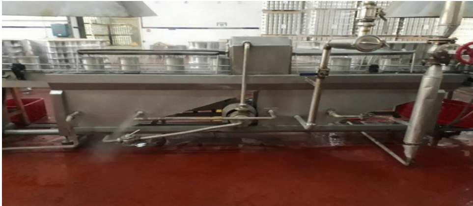
Figure 21 : Opération de Jutage
