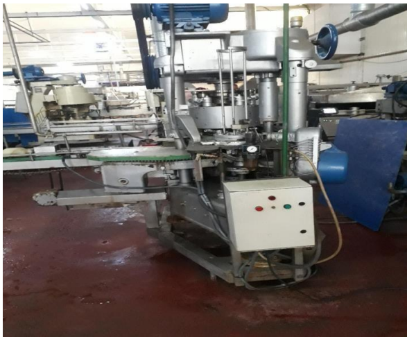
Figure 22 : Opération de sertissage
