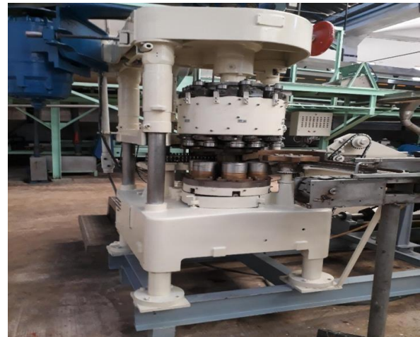
Figure 22 : Opération de sertissage
