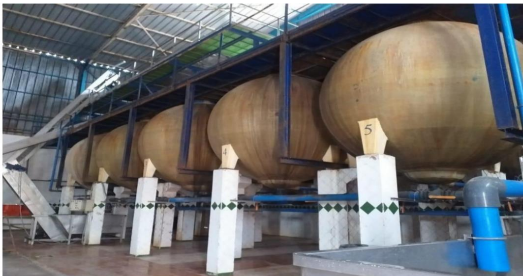
Figure 15 : Citernes de désamerisation
