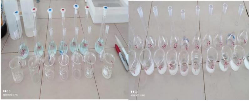
Figure 6: Une gamme standard (0,5ppm-3,5ppm) à base de  $KNO_3$  et tube conique de 50 ml et solutions d'étalonnages respectivement.
