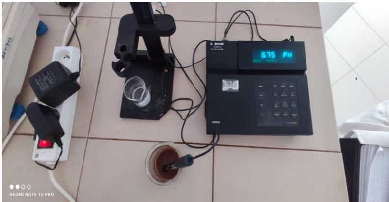
Figure 4: mesure du pH avec un pH-mètre.
