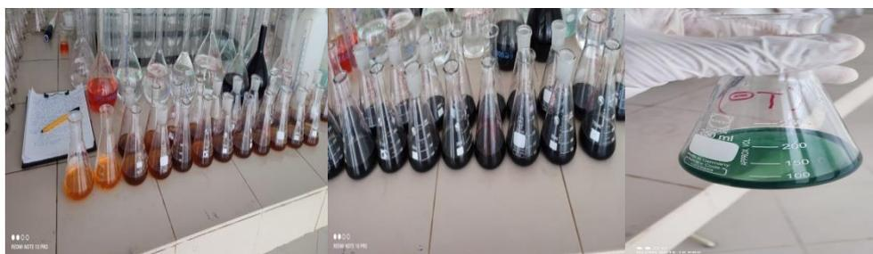
Figure 5: Avant et après d'ajouter l'indicateur coloré au mélange réactionnel et Après titrage avec une solution de sulfate de fer, respectivement.
