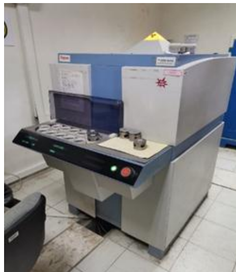
Photo 20 : Le Spectromètre à fluorescence XR (laboratoire de l'usine de LafargeHolcim Fès 2022)
