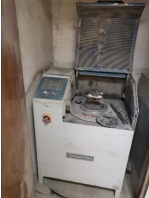
Photo 19 : Le sur-Broyeur (laboratoire de l'usine de LafargeHolcim Fès 2022)
