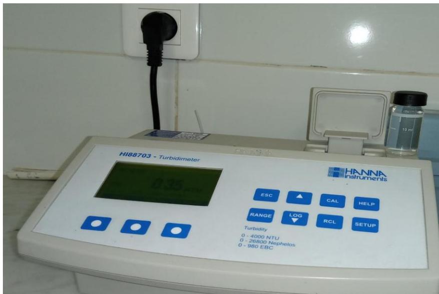
**Figure 13** : turbidimètre
