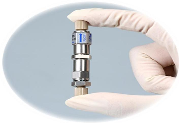
Figure 12: Colonne ARAKRAY échangeuse d'ions
