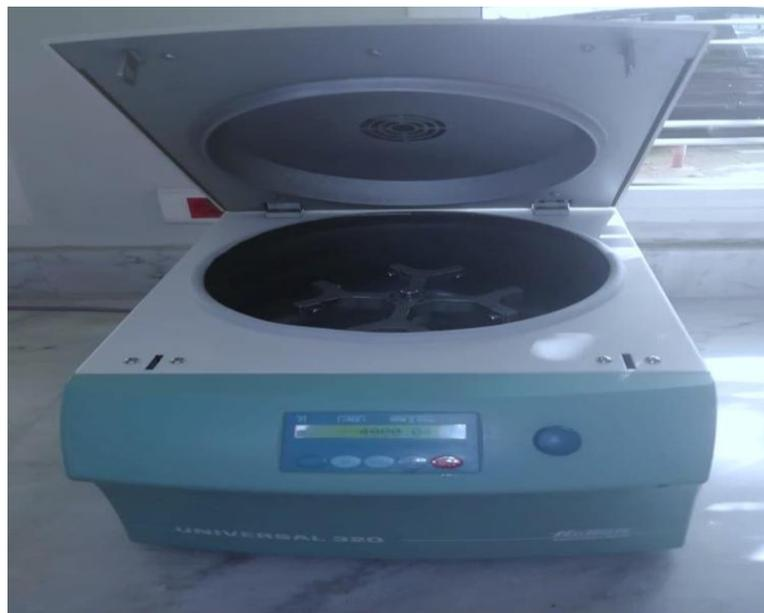
Figure 8 : Appareil de centrifugation
