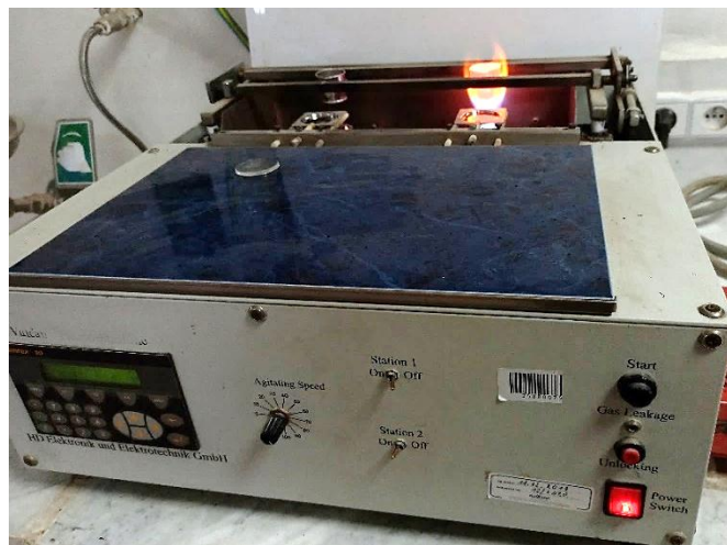
Figure 16 : Perleuse appareil sert à perler les échantillons.
