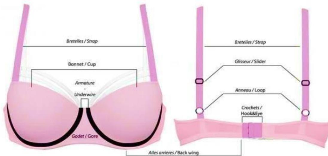
**Figure 3.1 : Description des composants d'un soutien TRIUMPH**
