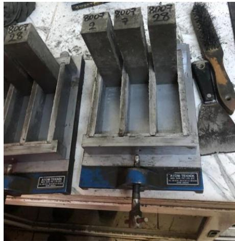
Figure 18: Eprouvette de Mortier
